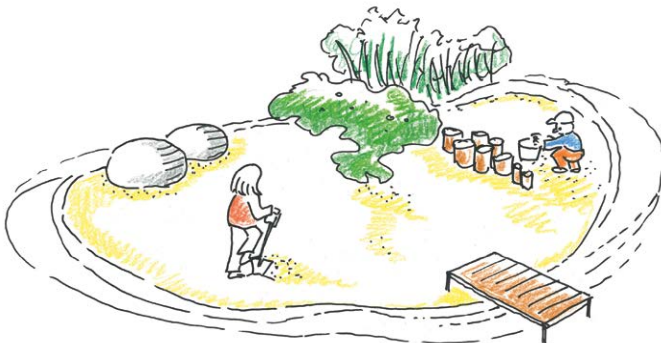
Große Sandspielflächen erweisen sich in der Praxis auch für größere Kinder als attraktiv. Mittels Ausbildung von Nischen wird gleichzeitiges konzentriertes Spiel mehrerer Kinder (und unterschiedlicher Altersgruppen) unterstützt. Darüber hinaus empfiehlt die ÖNorm B 2607 die Ausführung von inklusiv bespielbaren Sandspielbereichen, z. B. eines multifunktional nutzbaren Sitz-Liegebrettes als Ergänzung.
