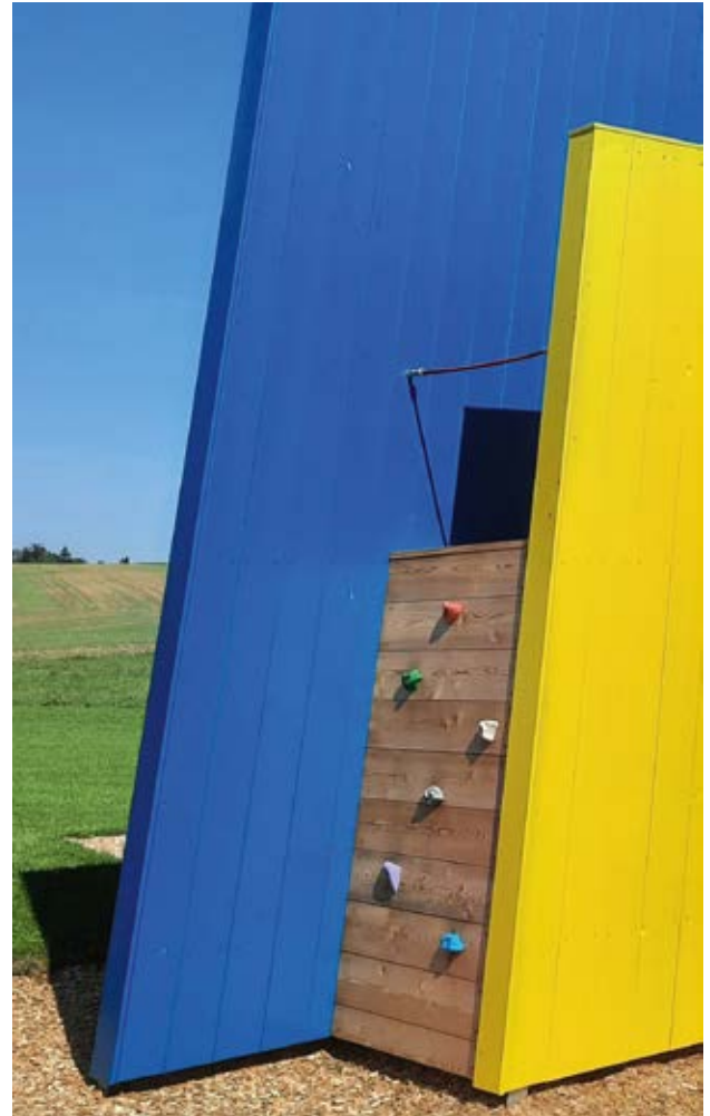
Einstiege (z. B. auf eine Plattform mittels Leiter oder Netz) dürfen max. 120 cm breit sein und müssen über eine Absturzsicherung verfügen. Bei Unterbrechungen unter 50 cm Breite kann diese entfallen.
